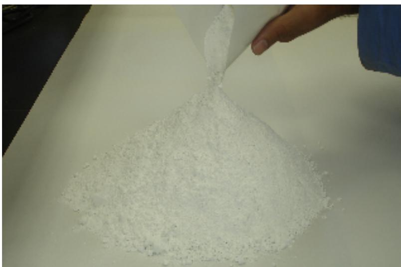
**Figura II.4 - Homogeneização do caulim em pilha prismática.**
