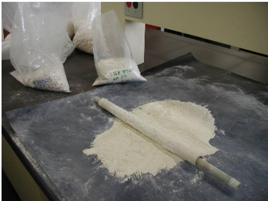
**Figura II.3 – Desagregação do caulim com rolo de PVC.**
