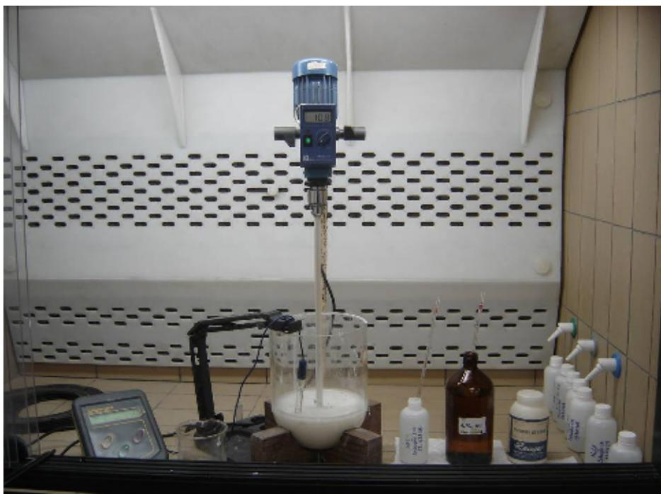
**Figura II.7 – Lixiviação redutora em meio ácido.**
