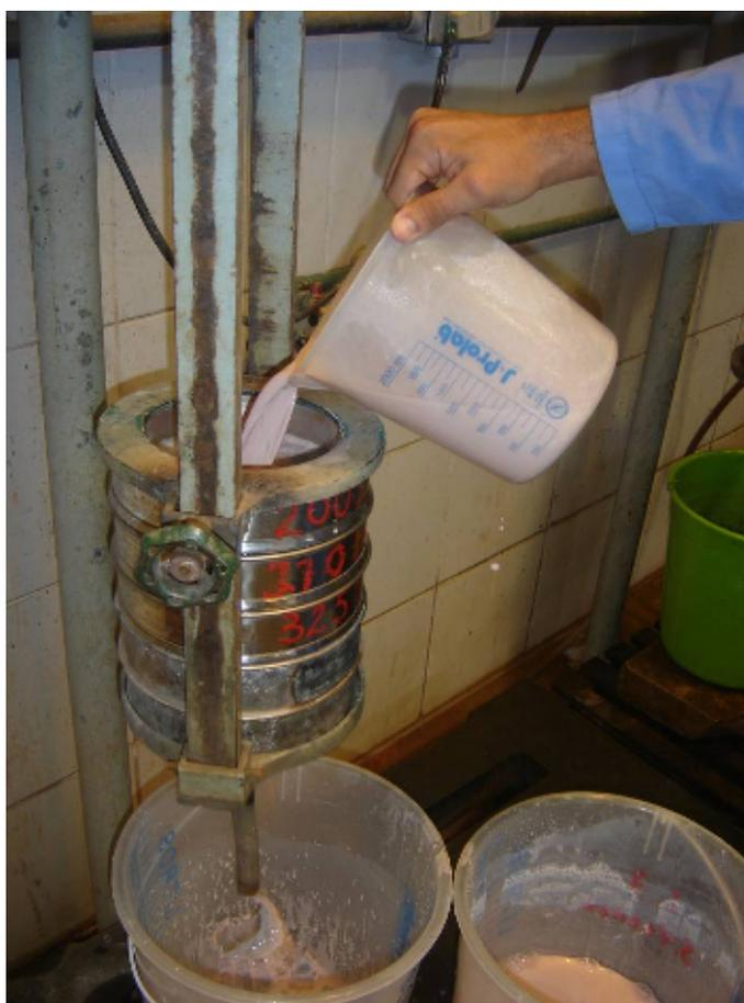
**Figura II.5 – Classificação granulométrica do caulim em polpa a 40% de sólidos.**
