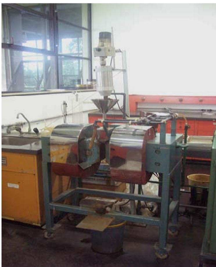
Figura II. 6 - Separador magnético de alta intensidade *Boxmag Rapid*.
