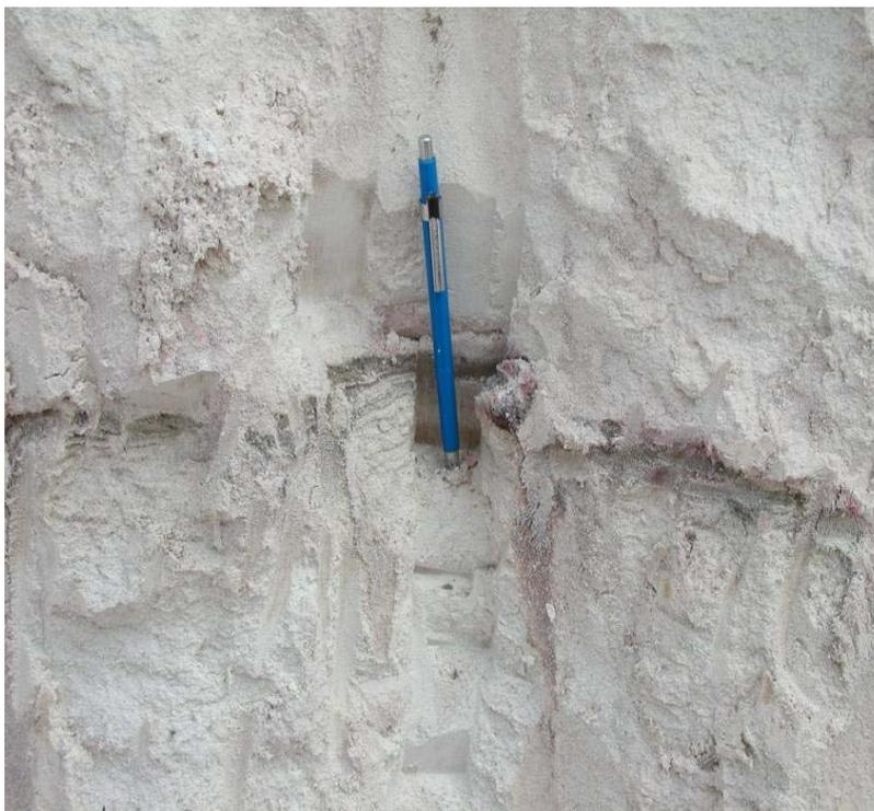
**Figura I.9 - Caulim do tipo arenoso.**
